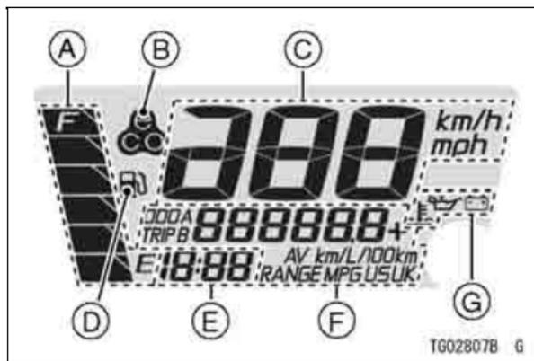
Al poner la llave de contacto en la posición "ON", las funciones se visualizan en la pantalla inicial con todos los segmentos LCD y, a continuación, el indicador multifunción pasa al modo operativo.
